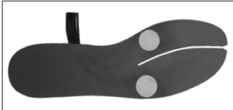
Abb. 1: Rechte Messsohle mit zwei Messstellen proximal von MTP I und MTP V (hellgraue Punkte) für die Ermittlung der Biege- und Torsionsbelastung
