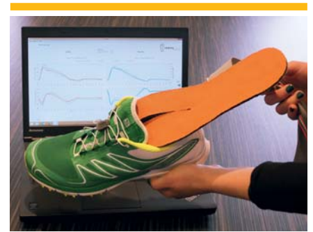
Bild 1: Neu entwickeltes Messsystem zur Erfassung von Biege- und Torsionsbelastung des Fußes im Schuh.
